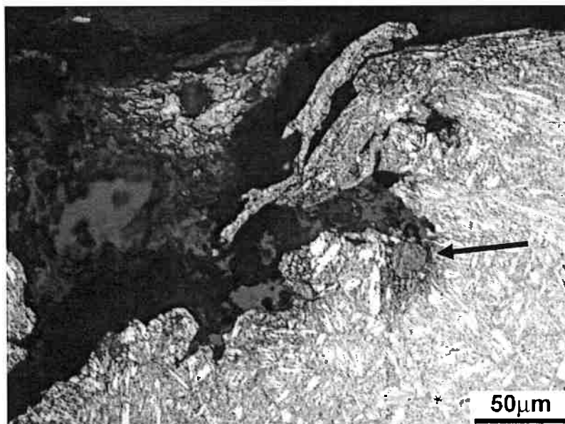
Figura 46: Corte longitudinal da superfície de fratura (local de início da trinca). Apresenta intensa deformação plástica superficial, seguida de trincamento e lascamento de material, adicionalmente, a presença de partícula incrustada (vide seta) – 500x – Palheta 4 [17]
