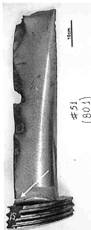
Figura 15: Palheta 51, presença de trinca na raiz, vide seta, e de regiões com deformação plástica e perda de material [17]
